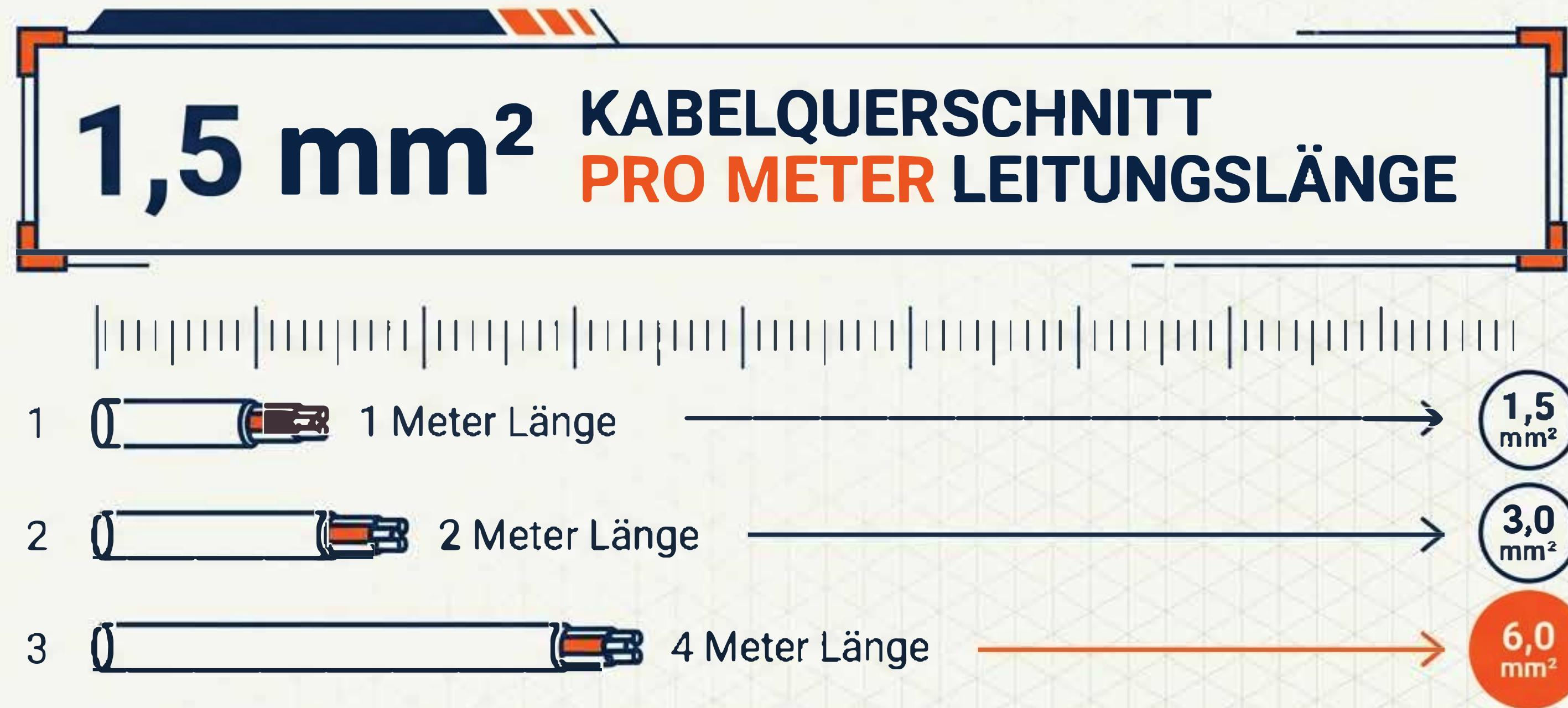
Mit zunehmender Entfernung muss der Querschnitt linear wachsen, um den Spannungsabfall zu verhindern.
